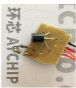
电源接线为红正黑负,测试时请先用 3V 供电,测试出声音后再进行相应功能调试。
